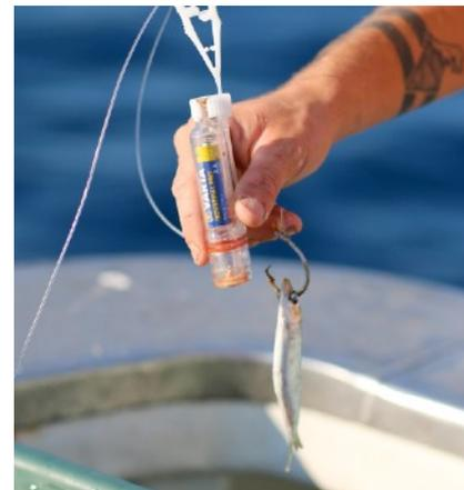
Figure 4. Photo du dispositif SHARKGUARD accroché au dessus de l'hameçon avant sa mise à l'eau
