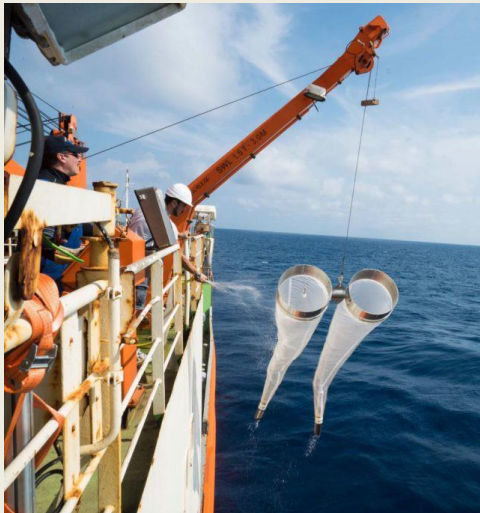
Tractage d'un filet de type bongo pour permettre l'échantillonnage des œufs et larves de poissons
