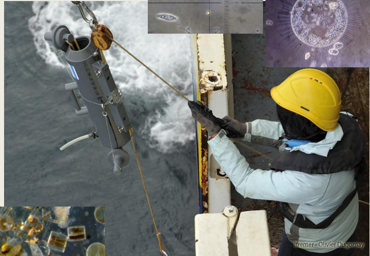
Mise en œuvre d'une bathysonde multi-paramètres (CTD) et prélèvement d'eau de surface à l'aide d'une bouteille « Niskin ».
